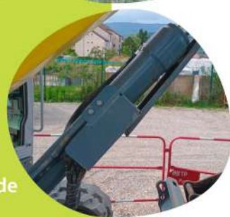
Clapet de sécurité sur le vérin de flèche
