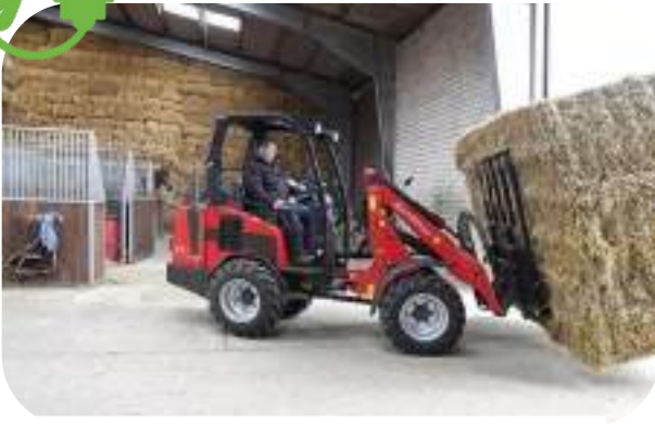
La chargeuse Schäffer 23 E est équipée d’un super chargeur permettant en 30 minutes une recharge à 80 % de la batterie lithium-ion. Elle est aussi capable d’aller à 20 km/h.
